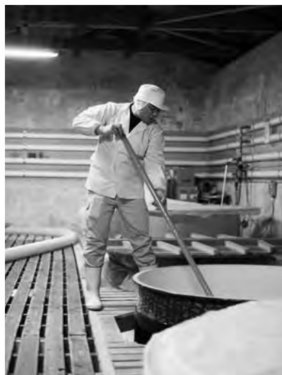
タンクに糶を入れて、必要な空気を行き渡らせて均一に発酵を進めます。醪の状態は刻一刻と変化していくので、厳重な温度管理のもとでこまめに糶入れが行われます。
